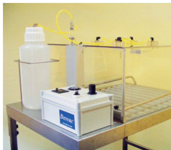
Рис. 2. Кабинетный спрейер Desvac Hatch Spray
