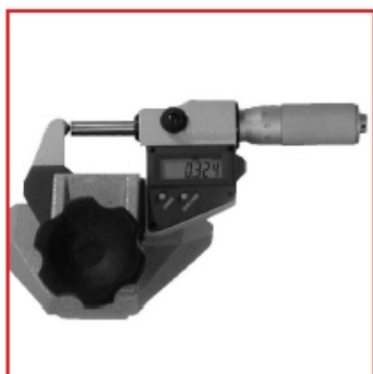
Цифровой микрометр Толщина скорлупы показывается на табло
